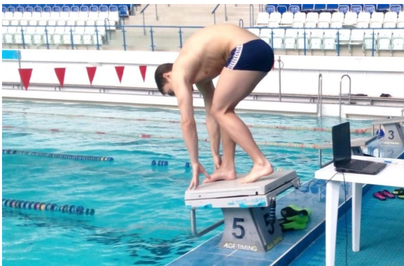
Рисунок 2. Применение тензометрии для оценки эффективности старта
